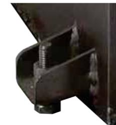
Les appareils sont équipés de pieds réglables. Le réglage des niveaux s'effectue par un système d'écrous et de contre-écrous qui garanti une bonne stabilité et procure un vide d'air sous le foyer.
